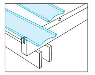
Первая панель Fastlock Uni нажатием малого буртика поверх первого ряда верхних фиксаторов. Крайний буртик крепится боковыми фиксаторами, которые прибиваются гвоздями к торцу стропила. Важно, чтобы оба паза малого буртика находились в зацеплении с крыльями верхнего фиксатора.
