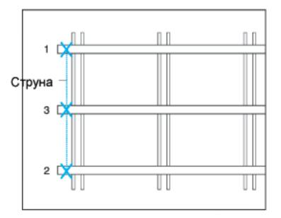
На первом и последнем стропиле отметьте места установки верхних фиксаторов. Натяните струну между этими точками и отметьте места установки фиксаторов на остальных стропилах. Затем прибейте первый ряд фиксаторов.
