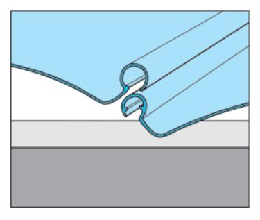
Панели соединяются друг с другом нажатием большого буртика поверх малого. Когда панели вошли в зацепление вы услышите щелчок. Когда панели соединяются в отсутствии обрешетки, необходимо рукой поддерживать панель снизу.
