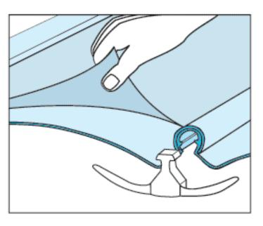
В случае, если скаты пологие (<3° или < 5%) с риском затекания воды под внутреннюю поверхность панелей, монтаж завершается установкой капельников в буртики простым нажатием. Важно, чтобы оба крыла капельника вошли в зацепление с пазами буртика. Наконец, с панелей снимается защитная пленка.
