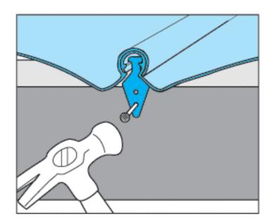
Прижмите панели вниз и закрепите фиксатор гвоздями так, чтобы панели лежали на основании.
