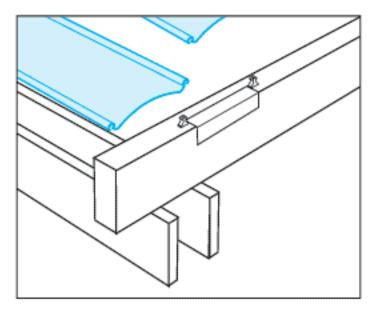
Используйте шаблон для правильного определения места расположения следующего ряда фиксаторов. Важно, чтобы фиксаторы располагались ровно, так чтобы они находились на одной прямой с фиксаторами на следующем стропиле.
