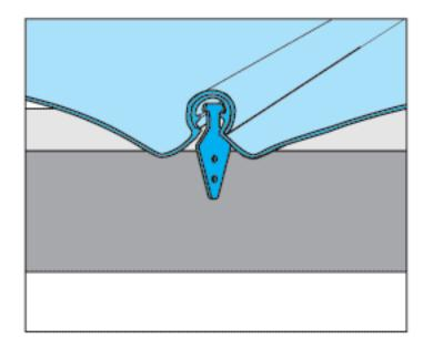
Фронтальный фиксатор вставляется в буртик и поворачивается на 90°. Таким образом, панели фиксируются. Важно, чтобы крылья фиксатора точно устанавливались в пазах буртика.
