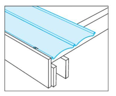
Следующая панель монтируется нажатием его большого буртика на малый буртик первой панели. Повторяйте эти операции пока не закончится крыша. Когда будет установлена последняя панель, боковым фиксатором завершите установку. Затем прибейте карнизную планку.
