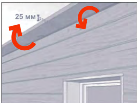
Отрежьте верх последней доски в продольном направлении до необходимой высоты, сохраняя минимальный зазор 25 мм между фасадом и кровельным свесом.
