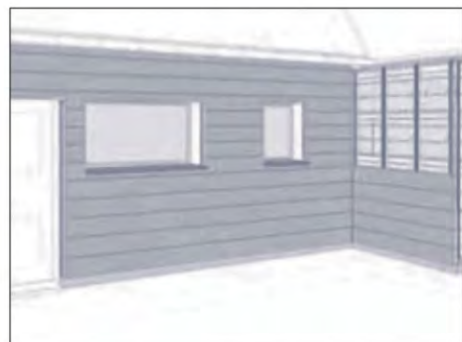
Теперь можно переходить к остальным стенам. Убедитесь, что на углах дома доски соединяются на одном уровне.
