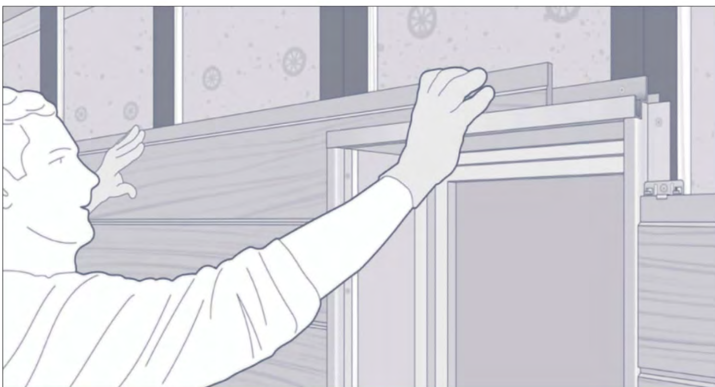
Продолжайте монтаж. Для монтажа доски над окном расчертите контур верха окна на задней стороне доски и обрежьте ее с помощью электролобзика (распиловка осуществляется с задней стороны доски). Убедитесь в том, что доска установлена над окном на одном уровне с другими досками в ряду, затем закрепите ее с помощью кляймера и самореза.
