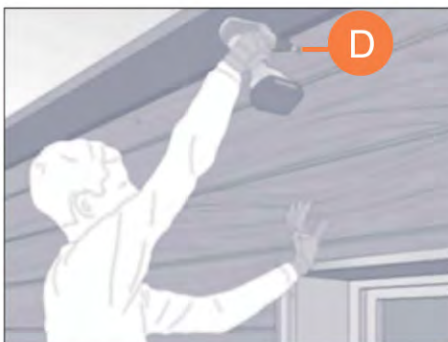
Прикрепите доску наверху с помощью гвоздей или саморезов и подкрасьте их. Также вы можете использовать саморезы с окрашенными шляпками в цвет материала.
