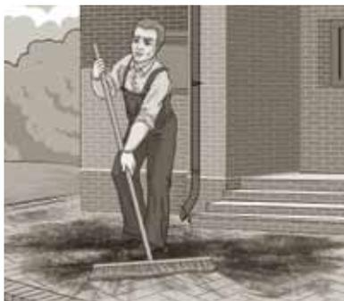
Швы финишно заполняются с помощью щетки. Для заполнения используют песок мелкой фракции ( $M_k < 2,0$ ). Пролитка швов способствует уплотнению песчаного заполнителя. Для заполнении швов можно использовать цветные смеси. Уплотнение облицовочного слоя производится при помощи виброплиты ( $m < 100$  кг) с защитной плитой из неопрена.
