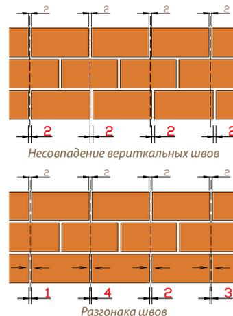
4. Заполнение швов производится в процессе укладки клинкера. Во избежание смещения кирпичей заполняются каждые 2 ряда.
